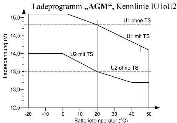
Bei 24V-Betrieb alle angegebenen Spannungen x2 nehmen !
