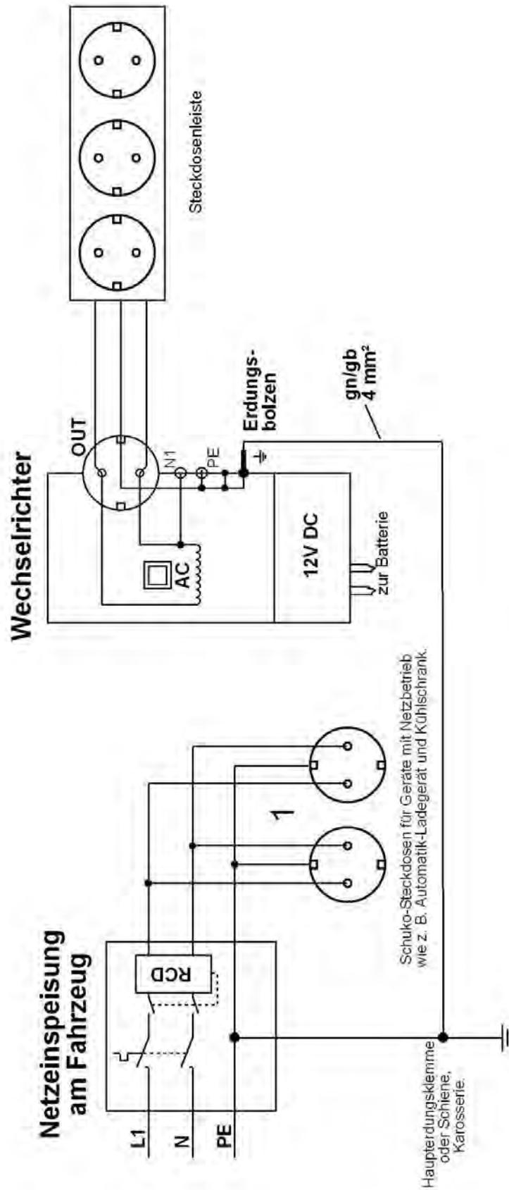
Die Steckdosenleiste wird an der Schuko-Steckdose „OUT“ des Gerätes angeschlossen. Die Steckdosenleiste soll laut Normung nicht fest installiert sein und die Verbindung des Erdungsbolzens am Wechselrichter mit der Potentialausgleichsleitung 4 mm<sup>2</sup> grün/gelb zur Haupterdungsklemme des Fahrzeugs dient dem Schutz bei möglichen Isolationsfehlern der angeschlossenen Geräte.
