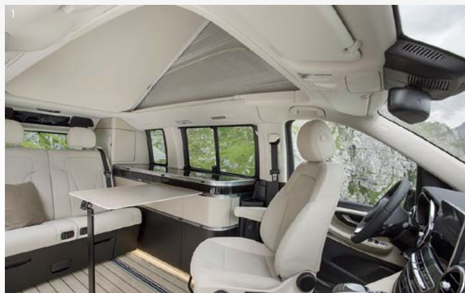
1 Exklusive Ausstattung mit Yachtboden, drehbaren Komfort-Fahrer- und Beifahrersitzen sowie mechanischem Aufstelldach für eine angenehme Stehhöhe
